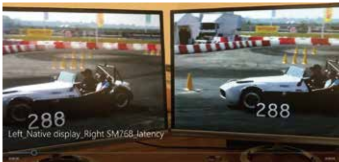
图 5：通过原来的显示器连接作并排测试的结果显示看不到 SM768 的延迟
