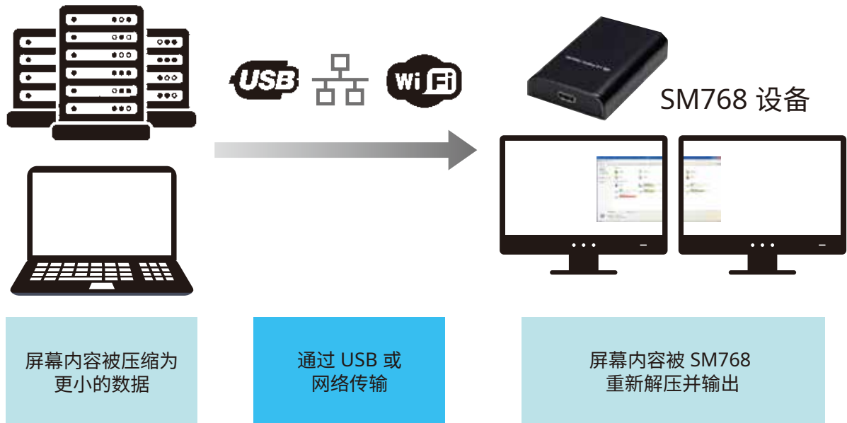
图 3: 图形信号被压缩以通过 USB 线, 或通过以太网或 Wi-Fi 网络传输
