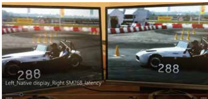
图 3：通过原来的显示器连接作并排测试的结果显示看不到 SM768 的延迟
