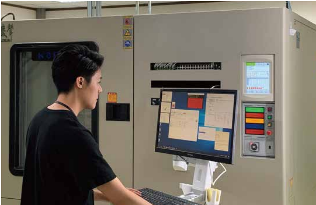
图三：采用 Chamber 进行高低温压力测试
