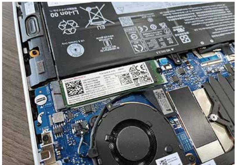
图一：SSD 固态存储设备已成为笔记本电脑的核心组件之一
