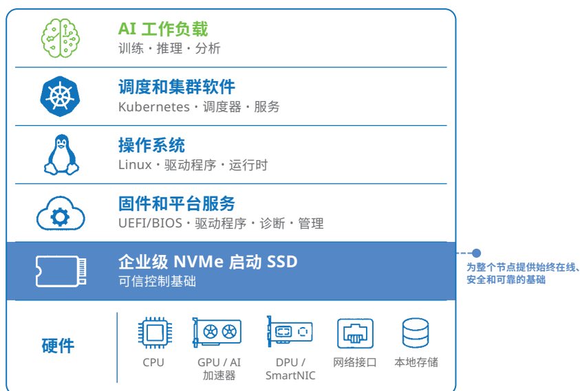
图 1：启动盘提供可信控制基础，可初始化 AI 云节点，将这些节点连接到调度和存储服务，并将工作负载数据与根卷分离。
