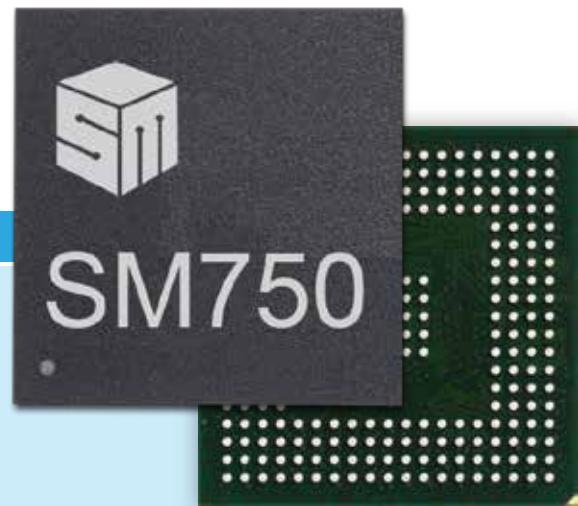
SM750 是 PCI Express 2D 多媒體行動顯示控制器裝置，採用 265 接腳 BGA 封裝。此款裝置經過專門設計，能夠滿足嵌入式產業的需求，並具備視訊及 2D 功能。為了降低系統成本，因此支援多種 I/O，包括類比 RGB 及數位 LCD 面板介面、兩種 Zoom Video 介面，以及脈衝寬度調制 (PWM)，同時提供 GPIO 接口以連接外部裝置。
