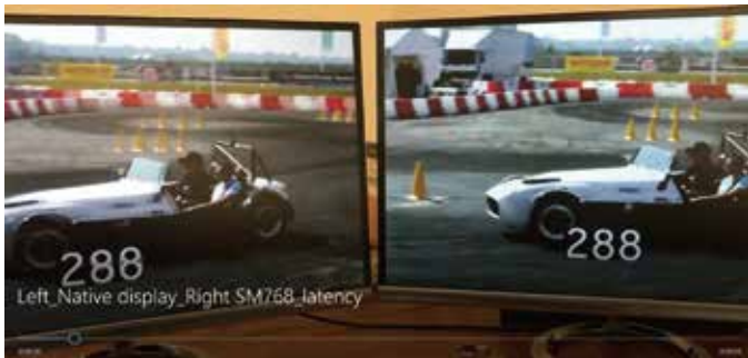
圖 5：並排測試，一台原生顯示器連接顯示 SM768 的難以察覺延遲
