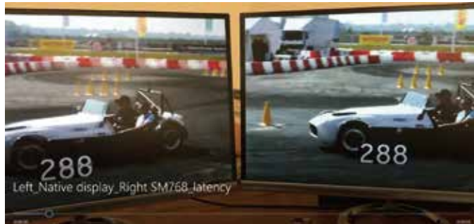
圖 3：並排測試，一台原生顯示器連接顯示 SM768 的難以察覺延遲
