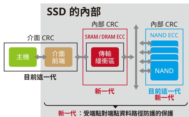
FerriSSD 資料復原演算法可有效偵測 SSD 資料路徑中的任何錯誤，包括 SRAM、DRAM 或 NAND 中產生的硬體（即 ASIC）錯誤、韌體錯誤和記憶體錯誤。最新一代的 FerriSSD 導入備援備份（SMI Ferri Group Page RAID），進一步消除無法修正錯誤的可能性。
