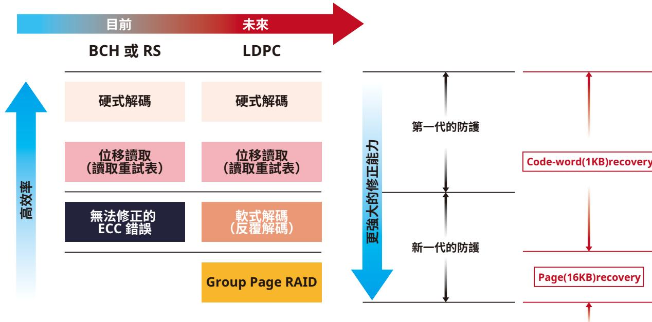
在累積使用（即 P/E）循環之後，NAND 記憶單元會開始退化，因而增加原始錯誤位元的機率與強度。Ferri NANDXtend 導入 SMI 的先進 Group Page RAID 演算法，修正較大的 16KB 字碼單元錯誤，與傳統 SSD 中使用的 1KB 字碼單元 ECC 引擎相比，提供重要的第二層防護。
