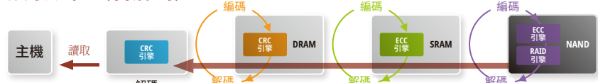
圖 4：端對端資料路徑保護可消除內部資料傳輸造成的位元錯誤
