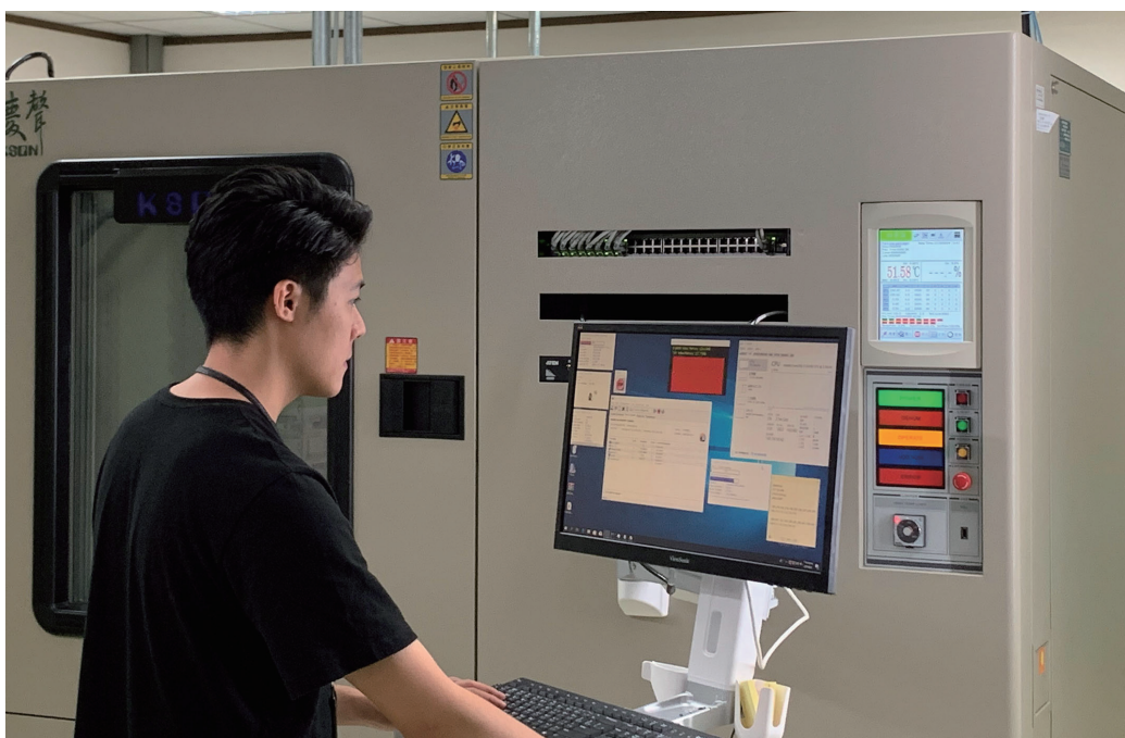
圖三：採用Chamber進行高低溫壓力測試
