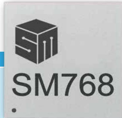
SM768は、デュアルディスプレイチャンネル、HDMI、ディスプレイポート、DVI、VGA、LVDSおよびデジタルインターフェイスを含む複数の出力インターフェイスをサポートする高性能グラフィックプロセッサです。128ビットのグラフィックエンジンを採用、画像表示処理を加速し、色空間変換およびスケーリング機能を提供します。最大4K UHD (3840x2160@30p) または2K/フルHD@60pに対応、H.264/MJPEGハードウェアビデオデコーディングをサポートしています。また、256MB DDR3メモリを単一の19x19mmパッケージに組み込むオプションもあります。
