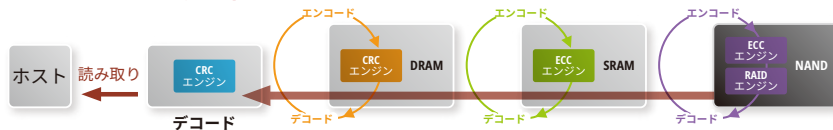
図4：エンドツーエンドのデータパス保護により、内部データ転送が原因のビットエラーを排除
