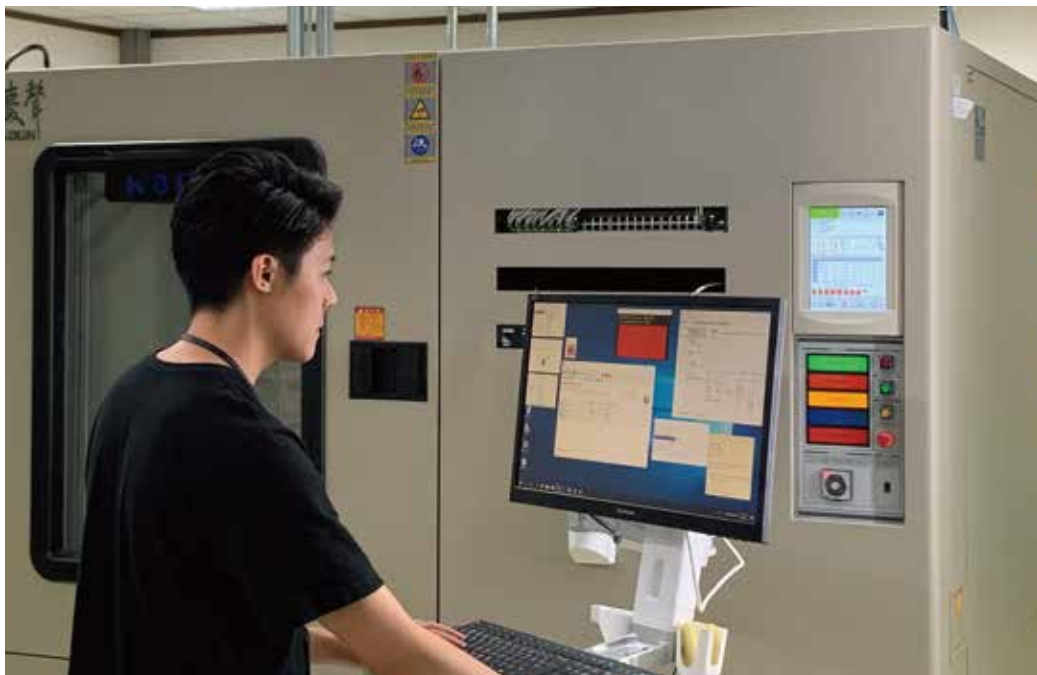
図3：チャンバーによる高低温ストレステスト
