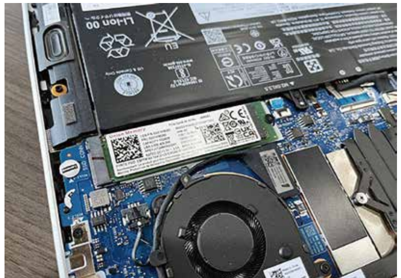
図1：ソリッドステートドライブ（SSD）は既にノートPCに欠かせない部品の一つ
