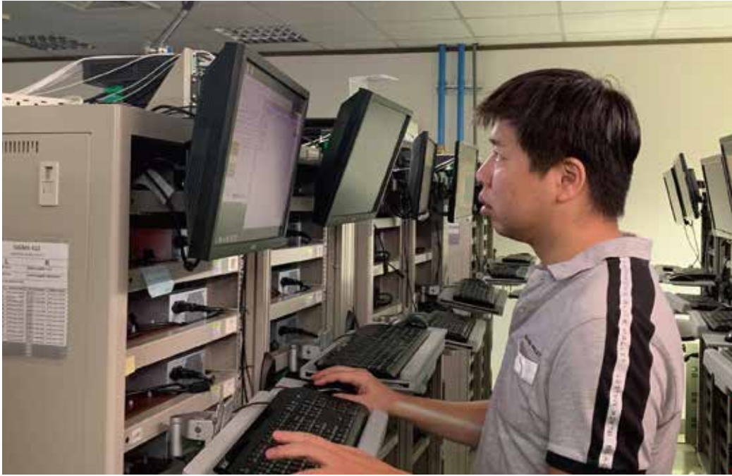
図2：電源オンオフ/スリープ解除圧力テスト
