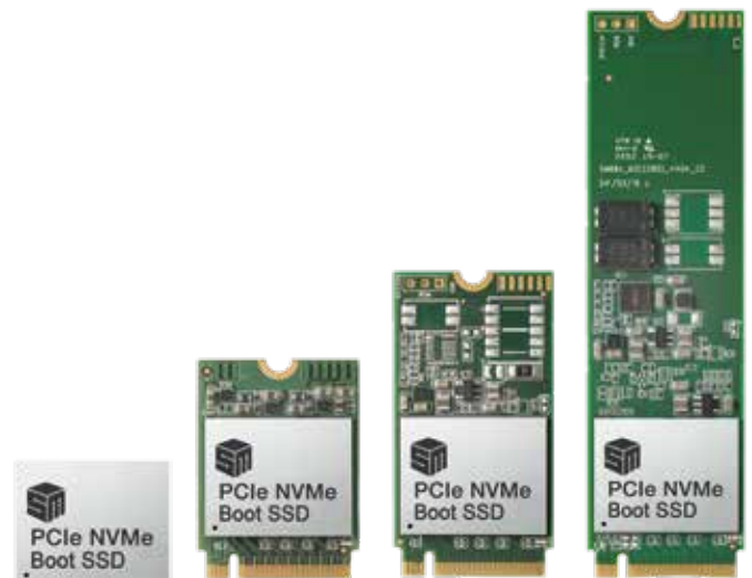
画像 1: Silicon Motion のエンタープライズ PCIe NVMe ブート SSD ソリューションは、BGA や M.2 をはじめとする多様なフォームファクタに対応しています。
