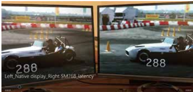
그림 5. 자체 디스플레이 연결과 나란히 비교한 테스트 결과 SM768의 대기 시간(지연)은 인지할 수 없는 수준이었다.
