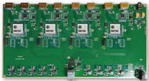
그림 3. 8개 디스플레이 비디오 월 구현을 위해 Silicon Motion사가 개발한 기준 설계
