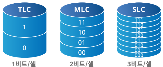
그림 1 - 여러 NAND 플래시 칩 제조사는 셀 하나당 2비트를 저장하는 MLC 기술 및 셀 하나당 3비트를 저장하는 TLC 기술을 개발했습니다.
