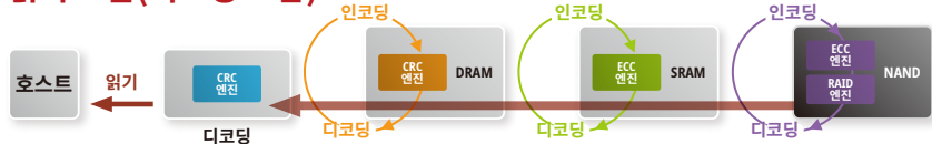
그림 4: 엔드-투-엔드 데이터 경로 보호 기능이 내부 데이터 전송으로 인한 비트 오류를 제거합니다
